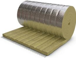
Matelas sur grillage en laine de roche avec une technologie de pointe concernant la non-absorption d'eau, cousu avec un fil d'acier galvanisé. Entre le grillage et la laine il y a une feuille d'aluminium.
